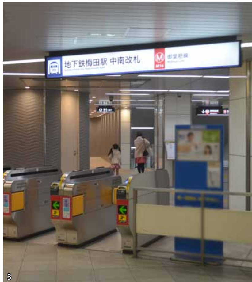
①③天吊り式サイン／H300×W2600×D110mm ベース：アルミ押出型材 表示：乳半アクリル+インクジェットシート出力貼り LED内照式 ②ポールサイン／H1750×W600×D20mm ベース：アルミ押出型材 表示：アルミ材+インクジェットシート出力貼り
