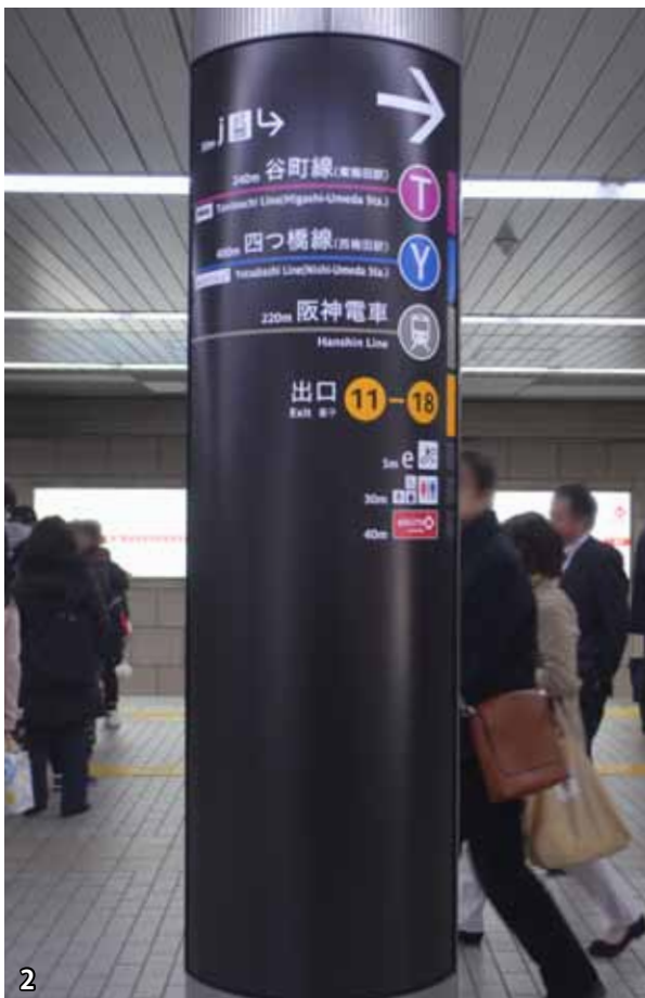
①③天吊り式サイン／H300×W2600×D110mm ベース：アルミ押出型材 表示：乳半アクリル+インクジェットシート出力貼り LED内照式 ②ポールサイン／H1750×W600×D20mm ベース：アルミ押出型材 表示：アルミ材+インクジェットシート出力貼り
